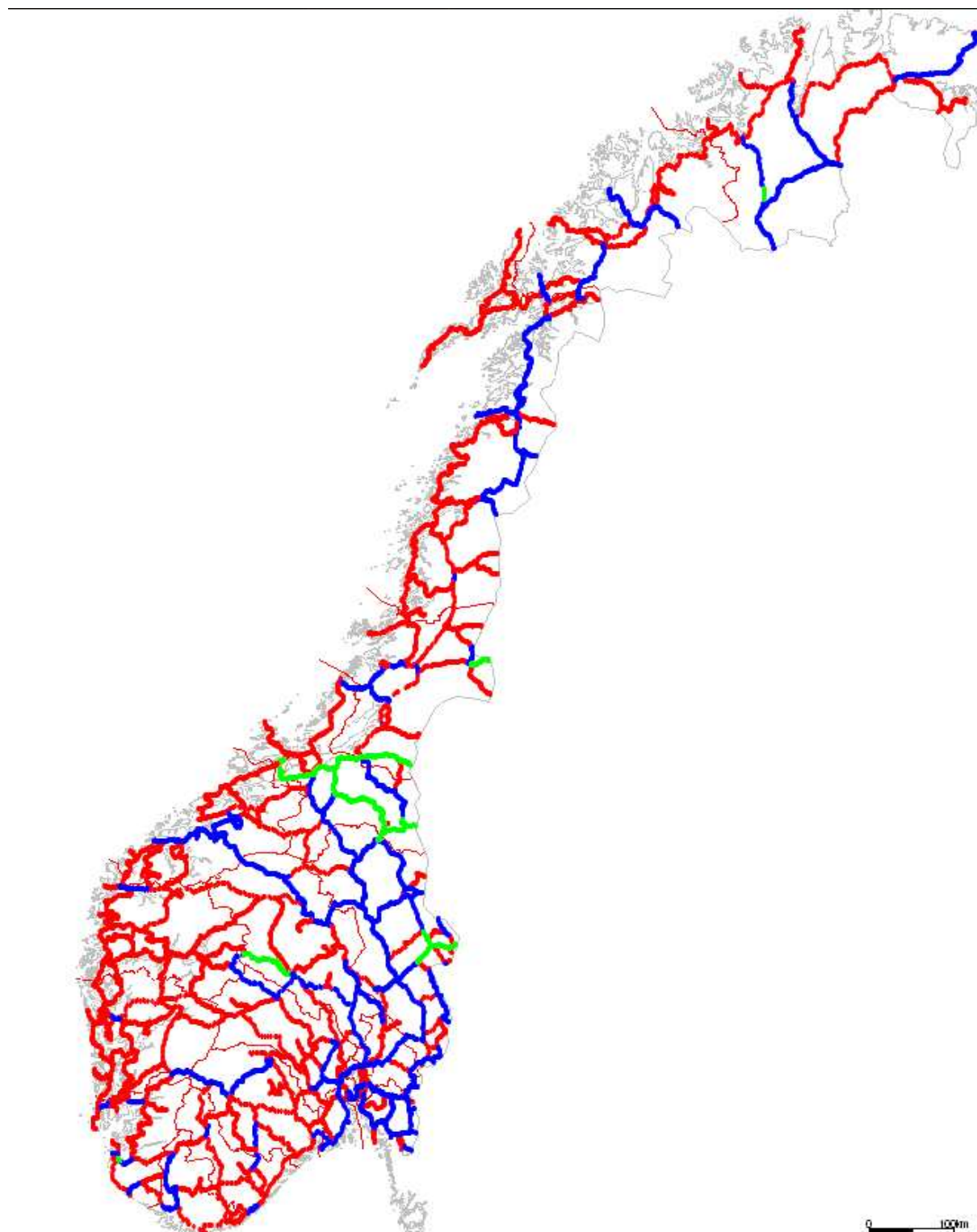
Figur 3. Fastmerkene i det norske presisjonsnivellementsnettet, status pr. 1. jan. 2010 Avstanden mellom fastmerkene er vanligvis ca. 1 km, noen steder 2-4 km. Blått: Målt to ganger. Grønt: Målt tre ganger.
