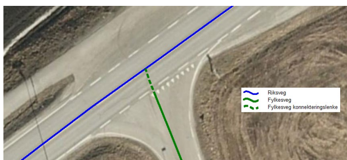
Figur 15 Konnekteringslenke mellom to veger
